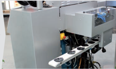
Kompaktes Entnahmehandling mit Teileabtransport auf der Maschinenrückseite
